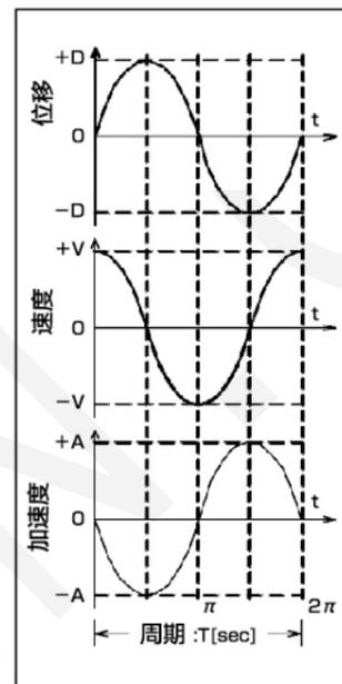
正弦波振动频率与位移，速度和加速度之间的关系。
